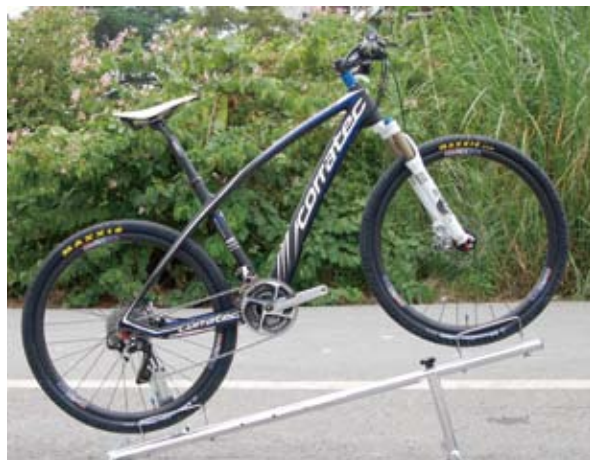
▲Corratec Revolution 經過年度大改款，採用弓形車架幾何設計，其中 Super light 版本的車架僅重 970g。
