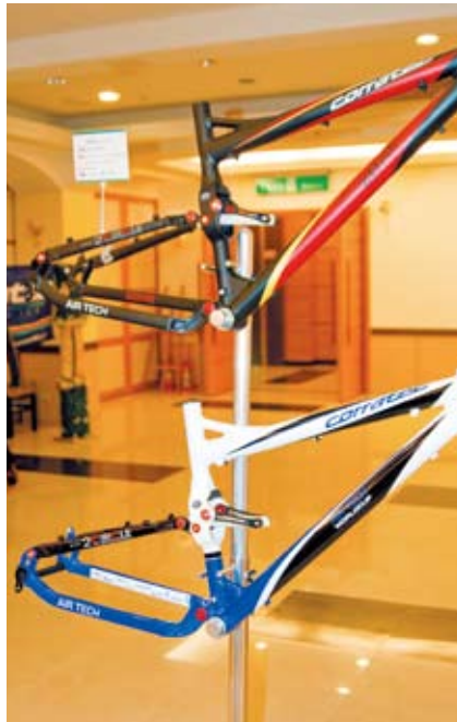
▲採用「2CIRCLE」概念的避震車架，強調不產生側向壓力。
