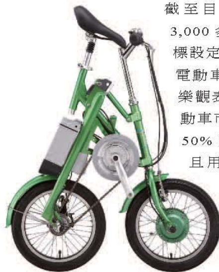
▲愛地雅最新 16 吋電動自行車，折疊後可推著行走攜帶相當方便。採用 Shimano 內三速及後碟煞系統，為踏力感測方式，搭配鋰電池或鎳氫電池，電力規格中最長續航力約 50 公里，充電時間約 4 小時。
