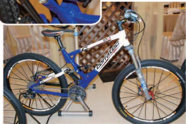
▲X-Force車款的內插式避震器設計，擁有靈活的接點調整空間，能配合車手習慣作改變。
